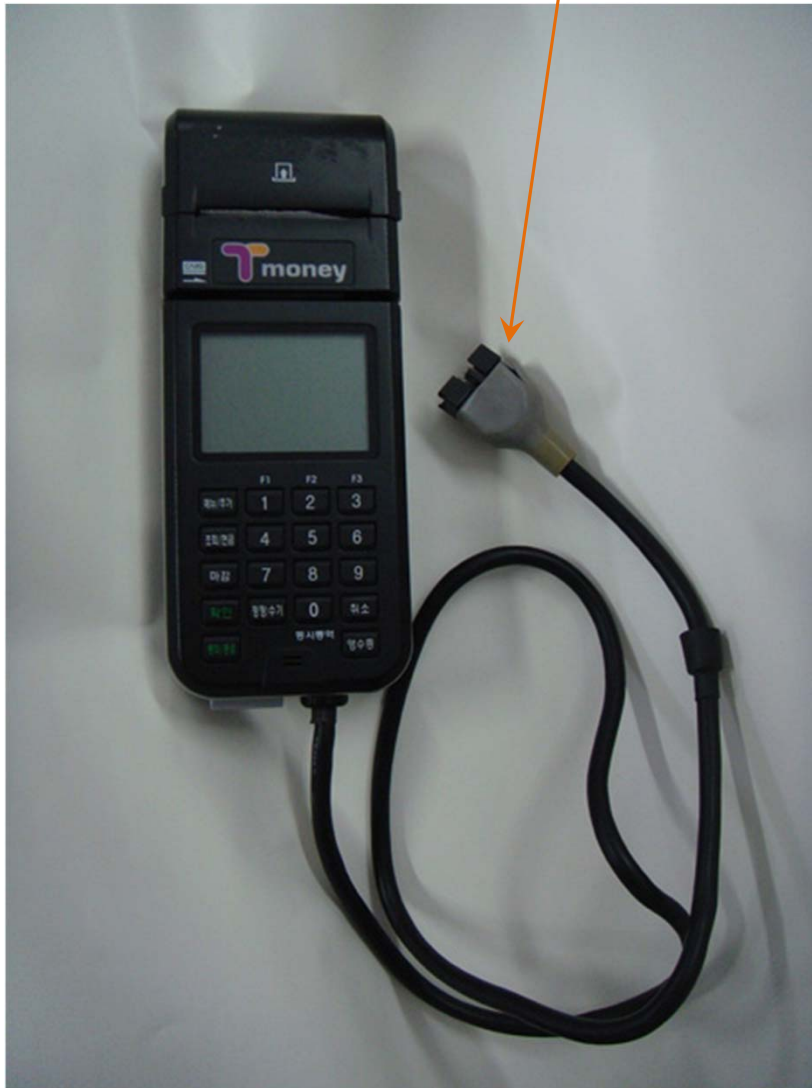
결제기케이블 전원 및 데이터연결
